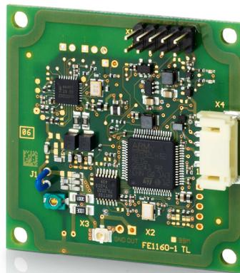
Der ID CPR70 ist mit lediglich 5 cm x 5 cm ein sehr kleiner RFID-Leser, der durch seine Vielseitigkeit besticht und allein schon aufgrund der geringen Abmessungen ein echter Alleskönner ist. Das hochmoderne Modul unterstützt kontaktlose Smartcards und Transponder gemäß ISO/IEC 14443 A/B, ISO 15693 und ISO 18000-3M3.
