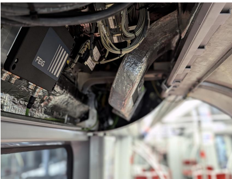
FEIG RFID-Reader ID LRU4000X im Fahrzeug (Quelle: FEIG)
